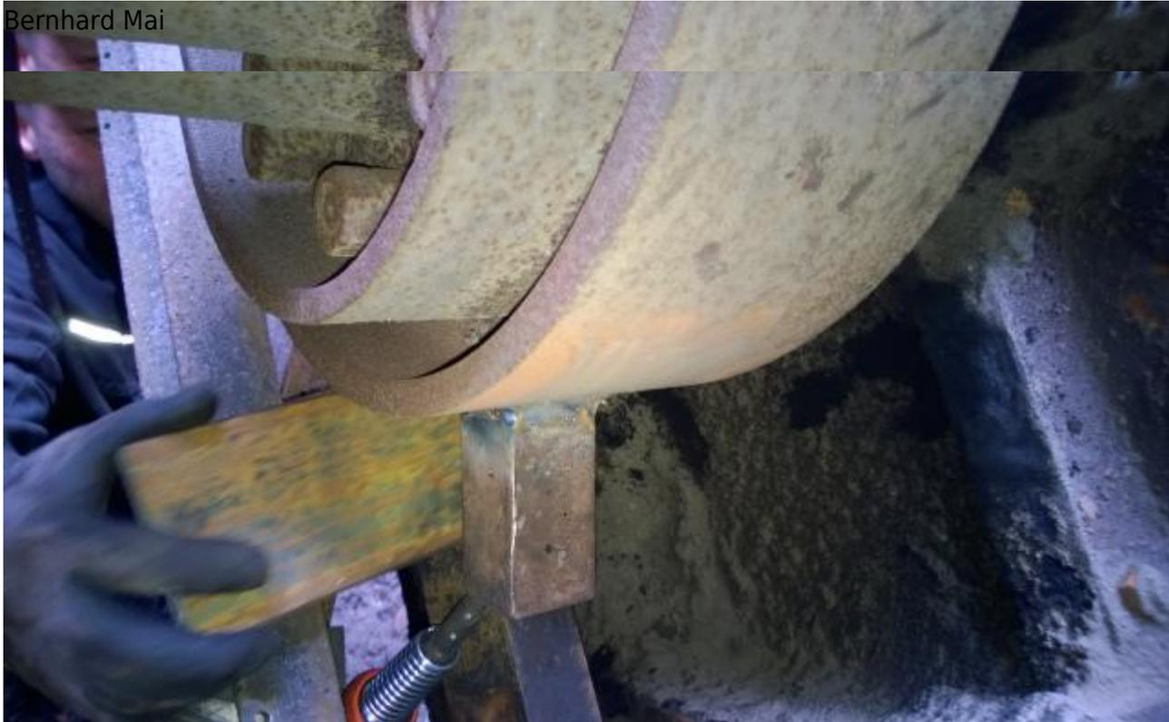
Hilfskonstruktion für den provisorischen Antrieb
