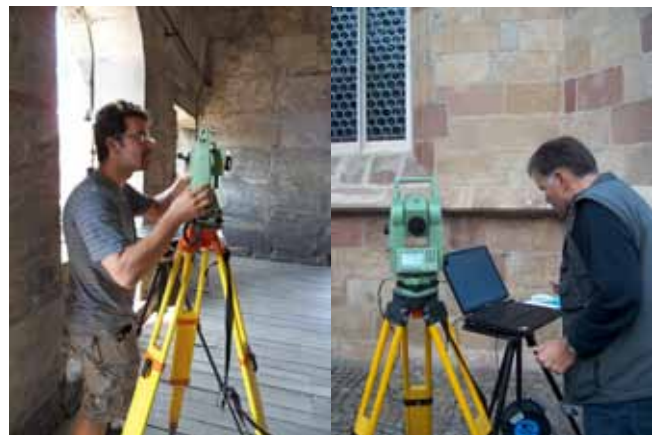
Abb. 8: Tachymetervermessung in der Porta Nigra in Trier und an der Pfarrkirche in Terlan
