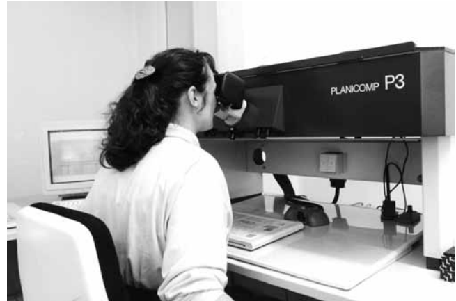
Abb. 16: Arbeit am traditionellen Stereoauswertegerät
