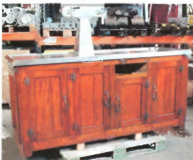
Illustration 11 : Le vernis est nettoyé et retouché autour des ferrures. De cette manière l'aspect total du comptoir est à nouveau représentatif, sans perdre son caractère comme objet d'usage courant.
