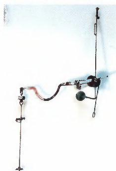
Illustration 15 : la découverte par hasard d'une aiguille avec des tiges dans un état fortement corrodé.
